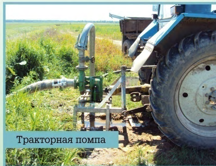
Передвижная насосная станция. Производительность от 60 до 1 250 м 3 час
